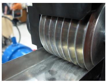
Ролик на второй (электромагнитной) стадии сепарации.
