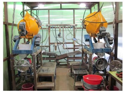
Высоконапорные бутары в геологоразведочном обогатительном модуле (ГРОМ.)
