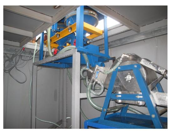
Мокрый магнитный сепаратор ММС-2ПМ в доводочном модуле ДМ-2
