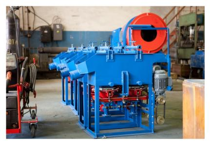
Отсадочные машины МОД-02СК в цехе
